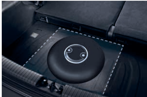
Tank unter der Ersatzrad Abdeckung mit 34 Liter Bruttovolumen ermöglicht nach DIN Verbrauch > 500 Kilometer Reichweite in LPG Betrieb.
