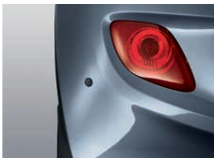
Einparkhilfe, fest verkabelt 4 Sensoren mit akustischer Meldung. Hinten T.-Nr. 9999Z-021360
