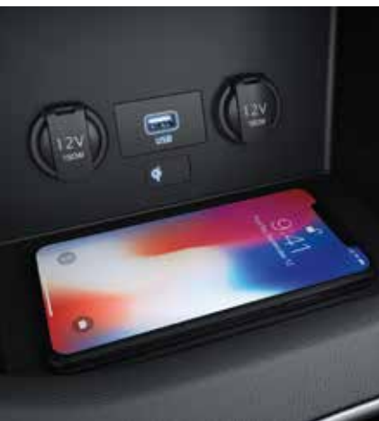
Smartphone-Ablage mit kabelloser Lade-funktion (Qi Standard)
